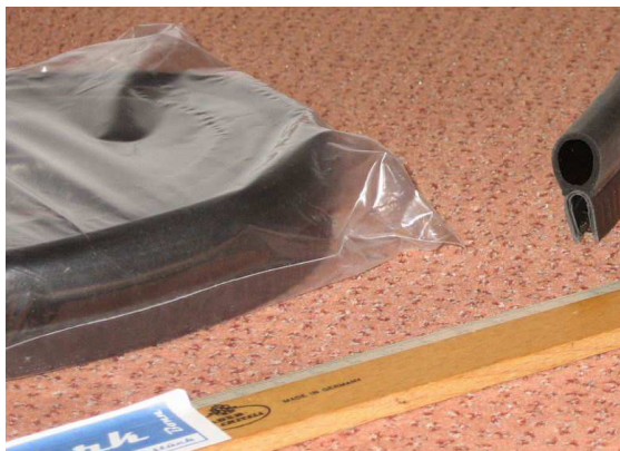
Dichtung Schottwand / Motorhaube 135 cm Teil 50
