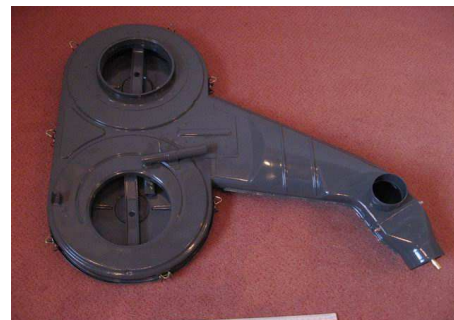
Luftfilterkasten mit Deckel gepulvert RAL 7043 (mit neuen Klammern und neuer Dichtung) Teil 31
