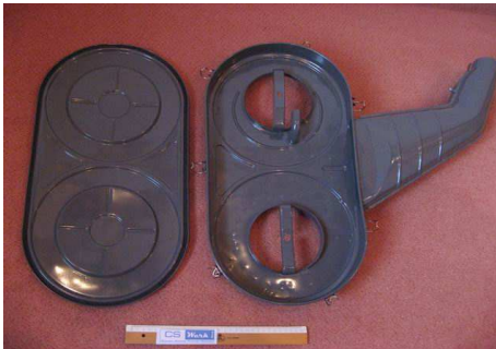
Luftfilterkasten mit Deckel gepulvert RAL 7043 (mit neuen Klammern und neuer Dichtung) Teil 31
